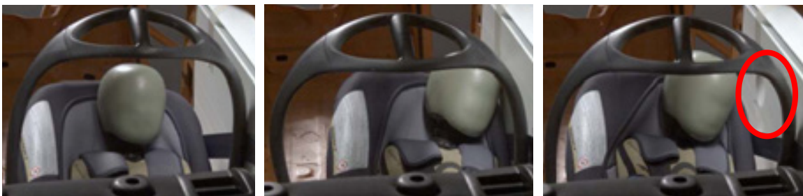
Figura 3: En el ensayo con el Nania Babyride, la cabeza del maniquí impacta casi sin protección contra las puertas del vehículo y produce en ellas una marca profunda
