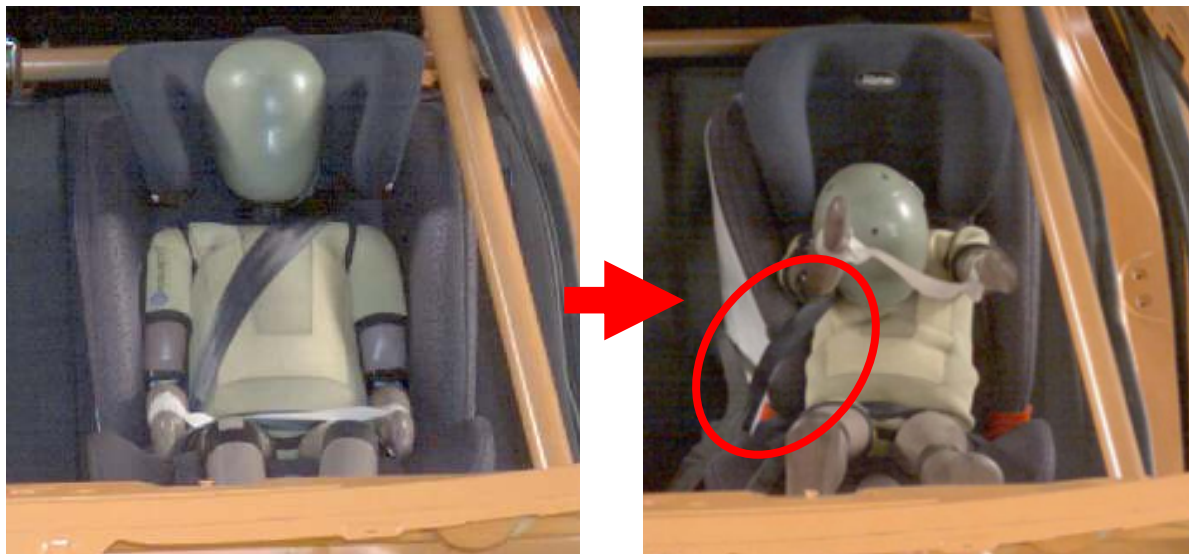
Figura 1: Ambos puntos de anclaje Isofix del Axxid Kidzofix fallan en el ensayo de choque.
