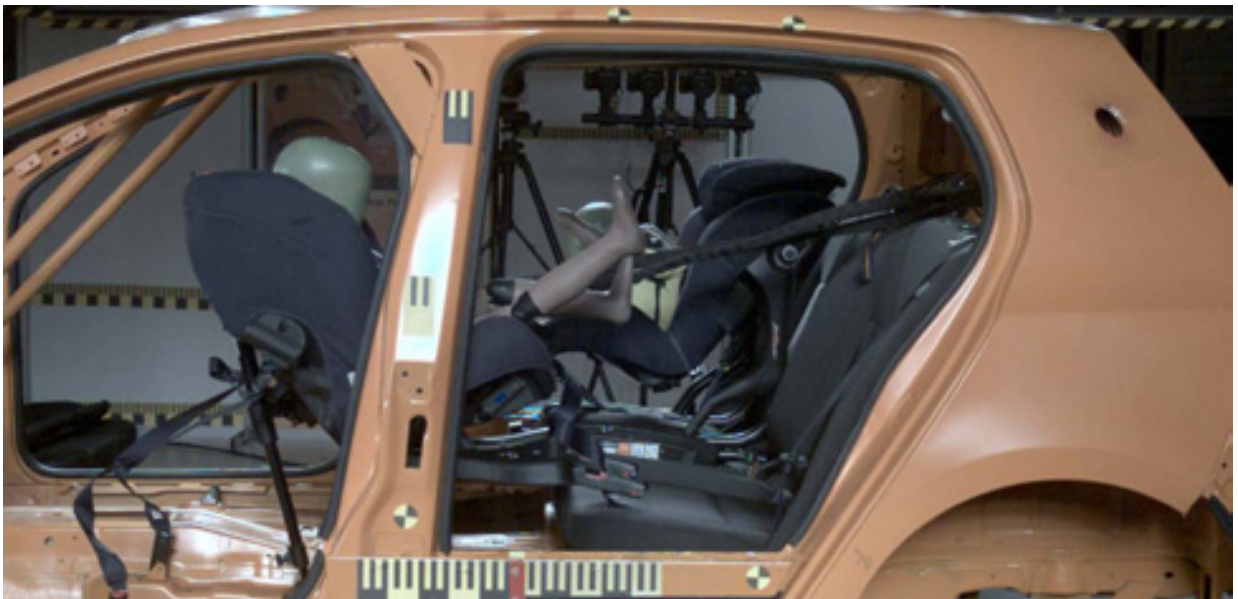
Figura 1: Ambos puntos de anclaje Isofix del Axxid Kidzofix fallan en el ensayo de choque.
